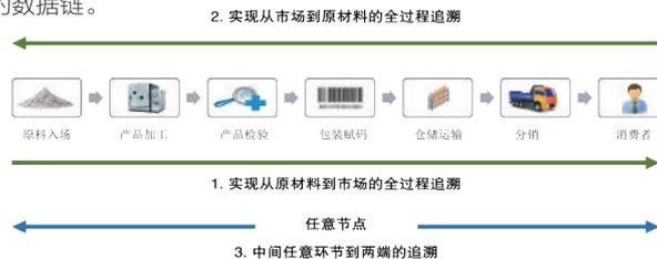
· MES 最终形成在“原材料 -- 》批次领料 -- 》工序生产 -- 》入库”完整的数据链,这个数据链用可用上述图形化的方式展示,每个节点代表一个追溯点,通过产品标识( 条码、二维码、DPM ),或者点击节点,可以查询每个追溯点的信息。
